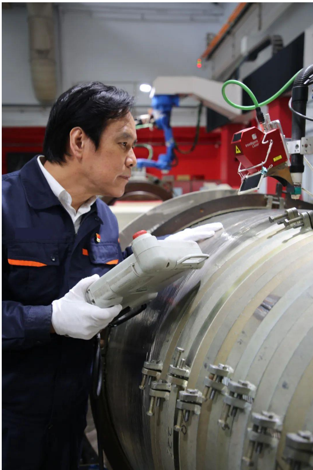
图 1、图 2 为火箭发动机喷管焊接场景，图 3 为激光跟踪仪进行坐标标定
